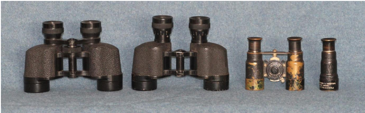
Afbeelding 1. Van links naar rechts: Wollensak 8x30CF (waarschijnlijk is dit een Wollensak Escort), Wollensak 6x30M met individuele scherpstelling aan beide oculairen, Wollensak 6x23 Biascope en de Wollensak Pockescope Sr.
