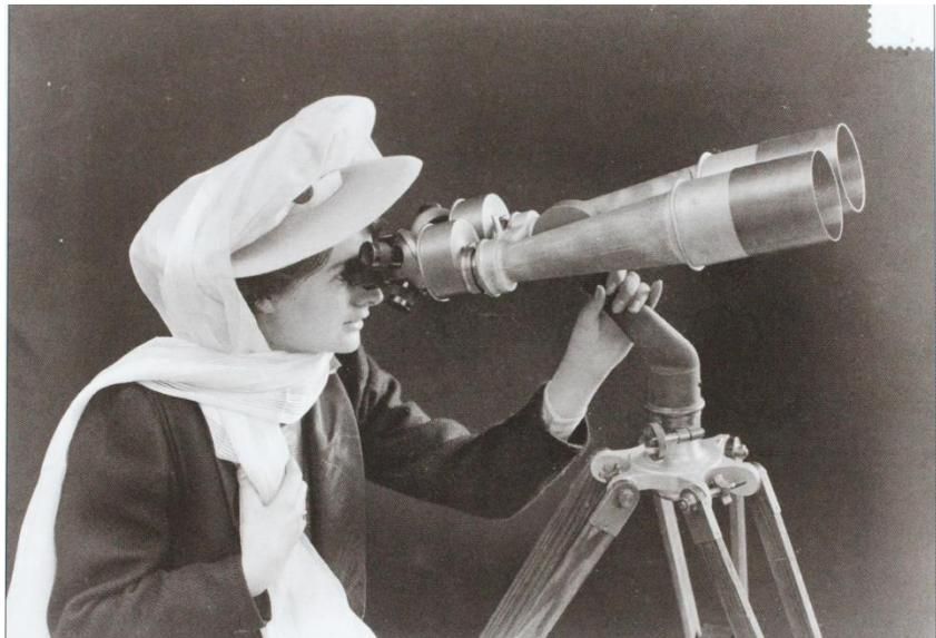
Das Aussichtsfernrohr für beidäugigen Einblick, mit einem Okularwechsler versehen, bietet die Möglichkeit, drei verschiedene Vergrößerungen einzustellen. (zwischen 1905 und 1910)
